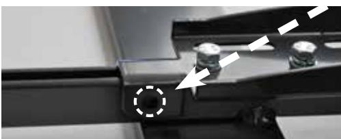
4) pour l'utiliser à l'extérieur, nous avons prévu la possibilité de bloquer ultérieurement le pied par un boulon transversant en perçant la barre transversale (mis en évidence dans la photo). Cette opération sera possible seulement une fois le porte-bagages placé et aligné sur le toit.
