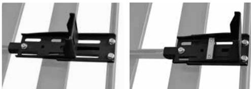
Se non si desidera montare il singolo piede sulla singola linea d'asse della traversa, abbiamo creato questo specifico adattatore **optional** (cod. **63-FEST**) che permette di fissare il piede all'interno della cornice del portapacchi. Nello stesso tempo, viene agganciato anche alla cornice perimetrale al fine di distribuire più uniformemente l'appoggio sul portapacchi. Le due foto spiegano il montaggio. Venduto a coppia con la bulloneria necessaria.
