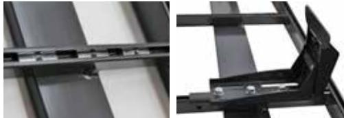
Eligiendo la **solución A** hay que seguir estas instrucciones: 3A) introducir las 3 tuercas rectangulares en el interior de la traviesa, luego fijar el pie con los pernos específicos sin apretar, ya que sólo con el portaequipajes montado y alineado será posible apretar todos los pernos.
