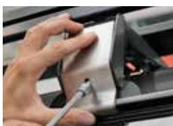
7) una volta posizionato il portapacchi sul tetto, fare scorrere i piedi al fine di allinearli simmetricamente in altezza ed in profondità.
