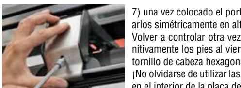
7) una vez colocado el portaequipajes sobre el techo, hacer deslizar los pies para alinearlos simétricamente en altura y profundidad.
