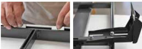
3B) introducir sólo un perno rectangular en el interior de la traviesa y los otros dos en el interior de la ranura del marco exterior. Fijar el pie con los pernos específicos sin apretar, ya que sólo con portaequipajes montado y alineado será posible apretar todos los pernos.
