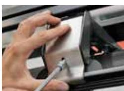
7) une fois le porte-bagages mis en place sur le toit, faites glisser les pieds pour aligner de manière symétrique aussi bien en hauteur qu'en profondeur.
