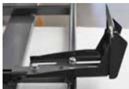
3B) insérer un seul boulon à tête rectangulaire à l'intérieur de la barre transversale. tandis que les deux autres sont à insérer dans le trou du cadre externe. Fixer le pied avec les boulons spécifiques sans serrer complètement, étant donné que seulement une fois le porte-bagages monté et aligné, Vous pourrez serrer complètement tous les boulons.
