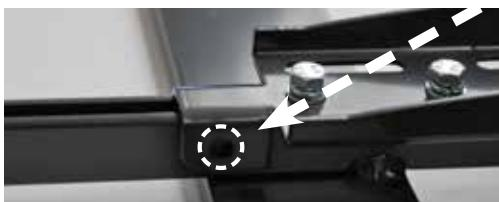
4) per utilizzo estremo, abbiamo anche previsto la possibilità di bloccare ulteriormente il piede con un bullone passante forando la traversa (evidenziato in foto). Questa operazione potrà essere fatta solo a portapacchi posizionato ed allineato sul tetto.
