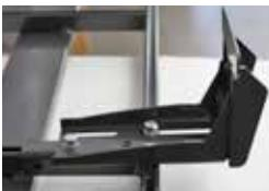
3B) inserire un solo bullone rettangolare all'interno della traversa mentre gli altri due vanno all'interno della fessura della cornice esterna. Fissare il piede con gli specifici bulloni senza stringere in quanto solo a portapacchi montato ed allineato si potrà serrare tutta la bulloneria.
