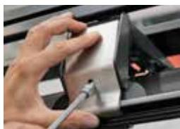
7) Nachdem der Gepäckträger auf dem Dach positioniert ist, die Füße verschieben, um sie symmetrisch in der Höhe und Tiefe auszurichten.
