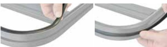
9) monter sur le cadre devant les 3 joints noirs en caoutchouc pour réduire le bruit du porte-bagages.
