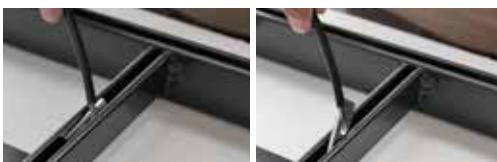
5) para recuperar las tuercas rectangulares del interior de las varias ranuras, en el equipamiento se suministra un imán adecuado que facilita la extracción.
