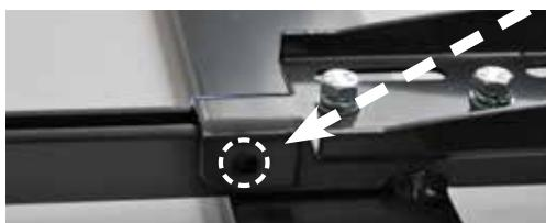
4) para el uso extremo, hemos previsto la posibilidad de sujetar más firmemente el pie con un perno prisionero perforando la traviesa (en evidencia en la foto). Esta operación puede ser realizada sólo con portaequipajes colocado y alineado sobre el techo.
